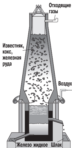
Рис. 7.5. Получение чугуна в доменной печи
